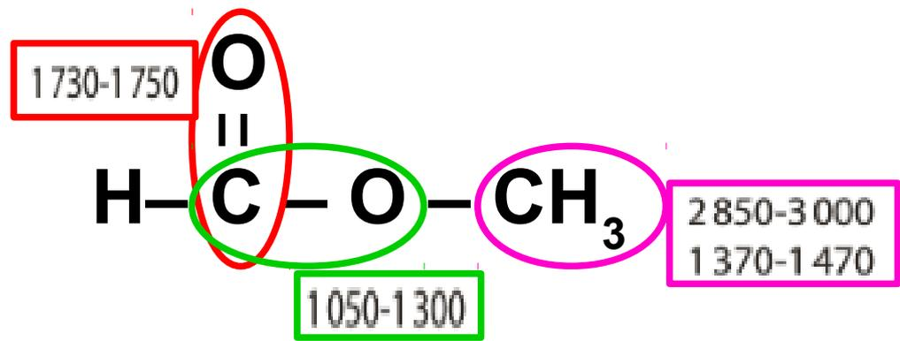
Son spectre est le n°3 : car le spectre n°1 n'a pas la bande d'absorption relative à la liaison C – O.
